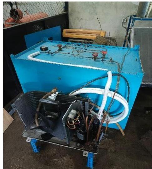
Gambar 1. Perangkat Pengujian AC dengan 3 katup paralel
